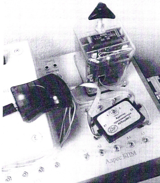
Рисунок 4.1 – Подключение программатора к БПМ
