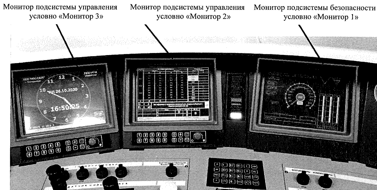
Рисунок 1.1 – Расположение мониторов на пульте управления электровоза 2ЭС6
