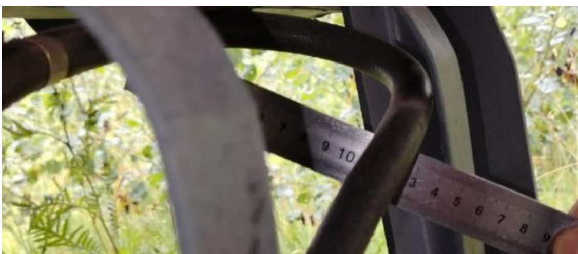
Рисунок Е.2 Диаметр изгиба менее 160 мм
