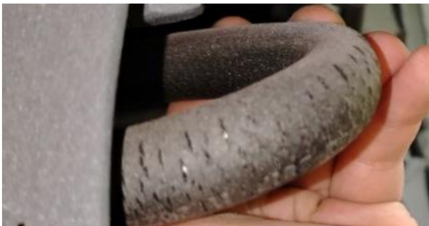
Рисунок Е.1 Пример поверхностных трещин
